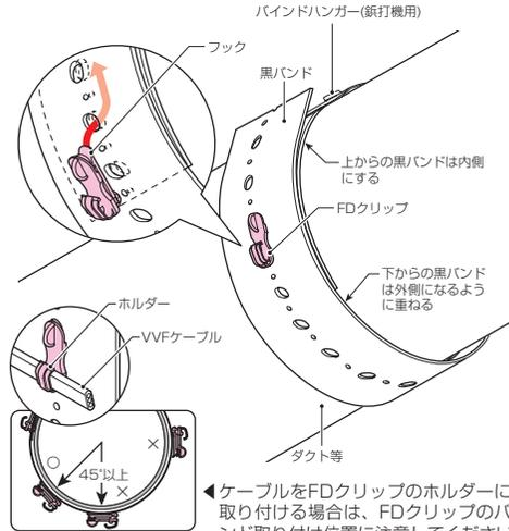
◀ ケーブルをFDクリップのホルダーに取り付ける場合は、FDクリップのバンド取り付け位置に注意してください。
