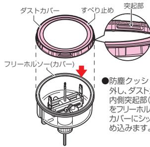
●防塵クッションを外し、ダストカバー内側突起部(4箇所)をフリーホルソーのカバーにしっかりとめ込みます。
