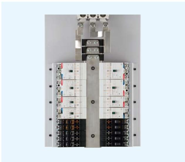
動力回路用および照明回路用の遮断器を同一盤内で取り付ける場合、KCシリーズ電源側プラグイン仕様(KCプラグイン)とBHミニシリーズ電源側プラグイン仕様(BHアダプタープラグイン)を合わせてご使用いただくことで、取付センターピッチを統一することが可能となります。
