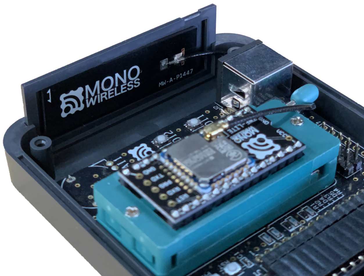
<図：樹脂ケース内に取付け>
