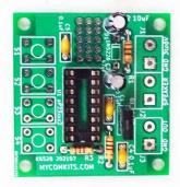
◆押ボタンスイッチ4個に電線を付け基板にハンダ付けする 注意:付属の押ボタンスイッチ4個にビニール電線(写真とは色 や形状は異なる場合があります)をハンダ付けし、その一方を 基板の「S1」、「S2」、「S3」、「S4」と印字されたハンダ端子(4つ の端子のうち手前の2つの端子、両端)にハンダ付けします。 注意:付属のビニール電線を使う必要はありません。AWG28程 MK-102B 列車の音が4種類!列車模型、時計、アラームに使える!列車音発生キット
