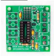
◆電解コンデンサー2個(10uF, 47uF)をハンダ付けする 注意:極性があります。プリント基板上の「+」の印字のあるハンダ端子にプラス側のリード線をハンダ付けします。
