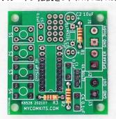
◆セラミックコンデンサーを3個(0.1uF。C1, C4, C5)ハンダ付け する
