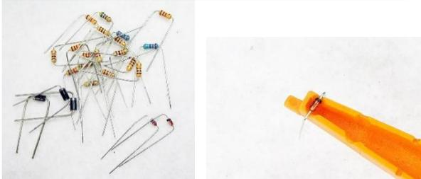
●小型ダイオード 1N4148 を 2 個実装します。極性(向き)がありますので注意してください。カソード側に黒い帯が印字されています。
