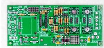
●青色と赤色の LED をハンダ付けします。極性があります。長いリード線がアノード、短いリード線がカソードです。プリント基板の LED の図にはカソード側に直線が描かれています。
