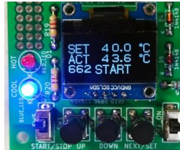
温度設定値を変更した直後は、設定温度に対して、対象物の温度が何度か(おおむね2、3回)、設定温度よりも高い温度または低い温度になり、最終的に設定温度で安定します。この現象は「振動する」と表現されています。この振動が少なくなるようにPID値を設定する必要があります。詳しくは「用語説明」を参照してください。
