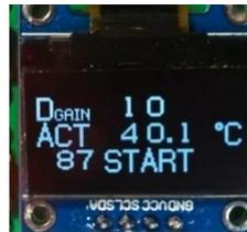
6. 電流制限値(LIMIT)の設定・・・D値の設定画面のときにNEXT/SET(次の画面)スイッチを押すと1行目に電流制限値としてPWM信号の最大パルス幅を表示します。その電流制限値を1から999までの範囲で設定します。UP(増)スイッチを押すと増加します。押し続けると連続して増加します。DOWN(減)スイッチを押すと減少します。押し続けると連続して減少します。最大値999に設定した場合、最大電流が流れることを示しています。**「最大電流」とは、接続したペルチェ素子とその電源装置により決定されず、たとえば接続されているペルチェ素子の最大電流が2Aで、接続した電源装置の最大電流が2A以上であれば、「最大電流」は2Aとなります。**PWM信号によりペルチェ素
