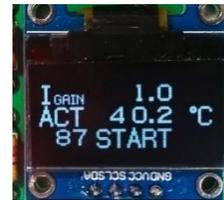
5. D値の設定(微分制御の係数の設定)・・・I(アイ)値の設定画面のときにNEXT/SET(次の画面)スイッチを押すと1行目にD値を表示します。PID制御方式により温度を制御しています。そのD値を1から99までの範囲で設定します。UP(増)スイッチを押すと増加します。押し続けると連続して増加します。DOWN(減)スイッチを押すと減少します。押し続けると連続して減少します。設定した値は不揮発性メモリ(電源をオフにしても消えない)に記録されます。
