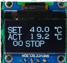
2. 温度を設定...電源オン後の初期画面のときに、UP(増)スイッチを押すと0.1°C設定温度(SET。1行目に表示)が増加します。押し続けると連続して増加します。DOWN(減)スイッチを押すと0.1°C設定温度が減少します。押し続けると連続して減少します。設定範囲は-99°Cから+99°Cまでです。写真の丸いキャップが付いた押ボタンスイッチの
