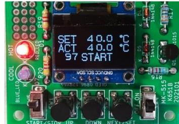
9. 温度制御の停止・表示画面に関係なく、開始/停止(START/STOP)スイッチ(SW5、スライドスイッチ、写真の左端)を下側にスライドすると温度制御を停止します。
