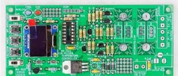
●電解コンデンサー47uFを1個ハンダ付けします。電解コンデンサーの極性(プラス記号)はPCB上にシルク印刷されていますので、注意深く確認し、リードを挿入しハンダ付けしてください
