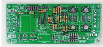
●ダイオード(1N4007)3本を向きに注意してハンダ付けします。カソード側に白い帯が印字されています。
