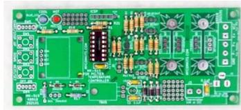
●タクトスイッチ 3 個(押ボタンスイッチ)をハンダ付けします。L
