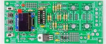
●トランジスタBC547を4個、BC557を2個、2SA1015を1個ハンダ付けします。すべて同じ形なので注意して素子に書かれている名前を虫メガネで確認してください。**注意：極性がありますので、正しい位置に、向きに注意して挿入しハンダ付けしてください。プリント基板にトランジスタの型番が印字されています。トランジスタの向きを示すために半円の形状がプリント基板に印刷されています。誤ると通電時に発火、発熱、する場合があります。**
