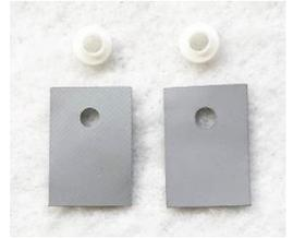
**注意：ネジ穴が開いている部分が金属製の IRF4905 を取り付けるときは絶縁ワッシャと絶縁シートを同時に取り付けます(写真参照)。**
