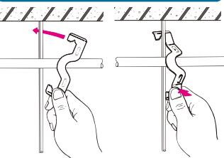
ツメ部分を片側ずつ吊りボルトにかけて取り付けることもできます。
