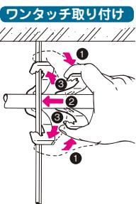
人差し指と親指で上下のツメ部分をしづり、矢印の方向にスライドさせて吊りボルトのセンターにツメのセンターが重なったら指を離します。
