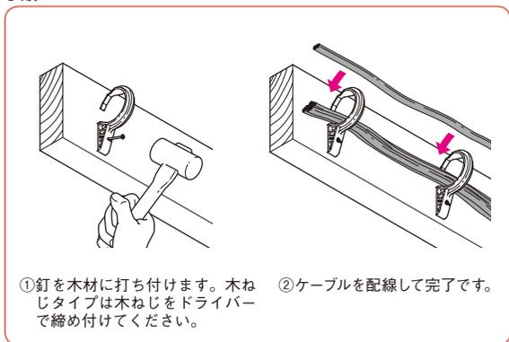
①釘を木材に打ち付けます。木ねじタイプは木ねじをドライバーで締め付けてください。
