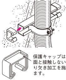
保護キャップは壁や天井面と接触しないように切り欠き加工を施してあります。
