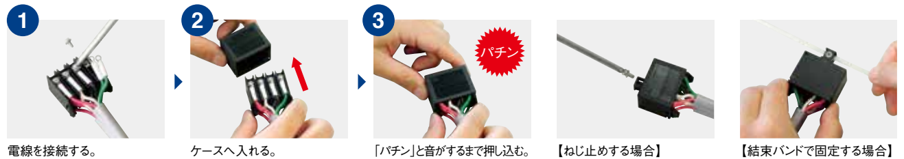
電線を接続する。
