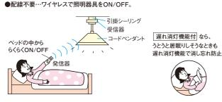
壁スイッチでのON-OFFはもちろんリモコンでOFFにした 場合でも壁スイッチでONにできます。その場合、2秒以内に OFF-ONしてください。
