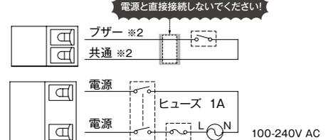
線種 | M1: AWG22×3 M2: AWG18×2 + AWG24×2 線長 | (500) ※1 無極性。UL仕様はクラス2でご使用ください。 ※2 ブザーなしの場合は配線不要です。
