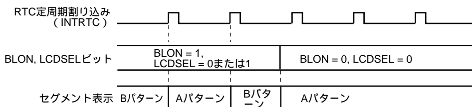
図21 - 15 点滅表示からAパターン表示への切り替え動作
