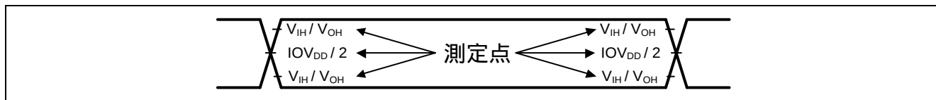
図 5.1 AC タイミング測定点
