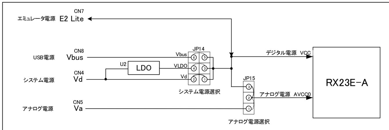
図 2.1 RSSKRX23E-A ボードの電源構成
