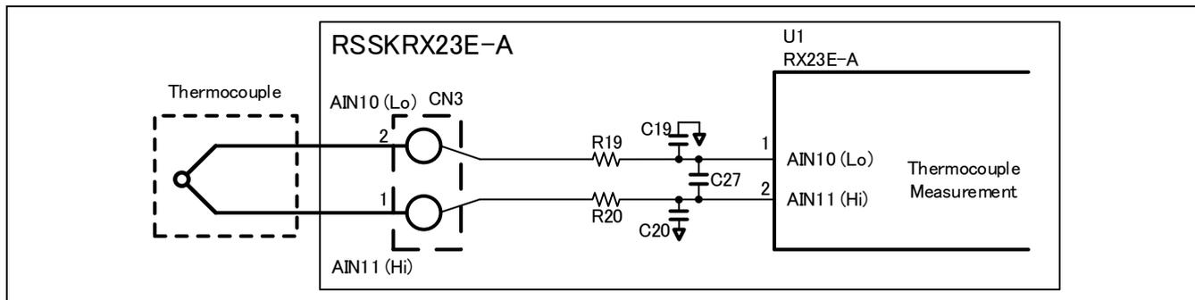
図 2.4 熱電対計測回路
