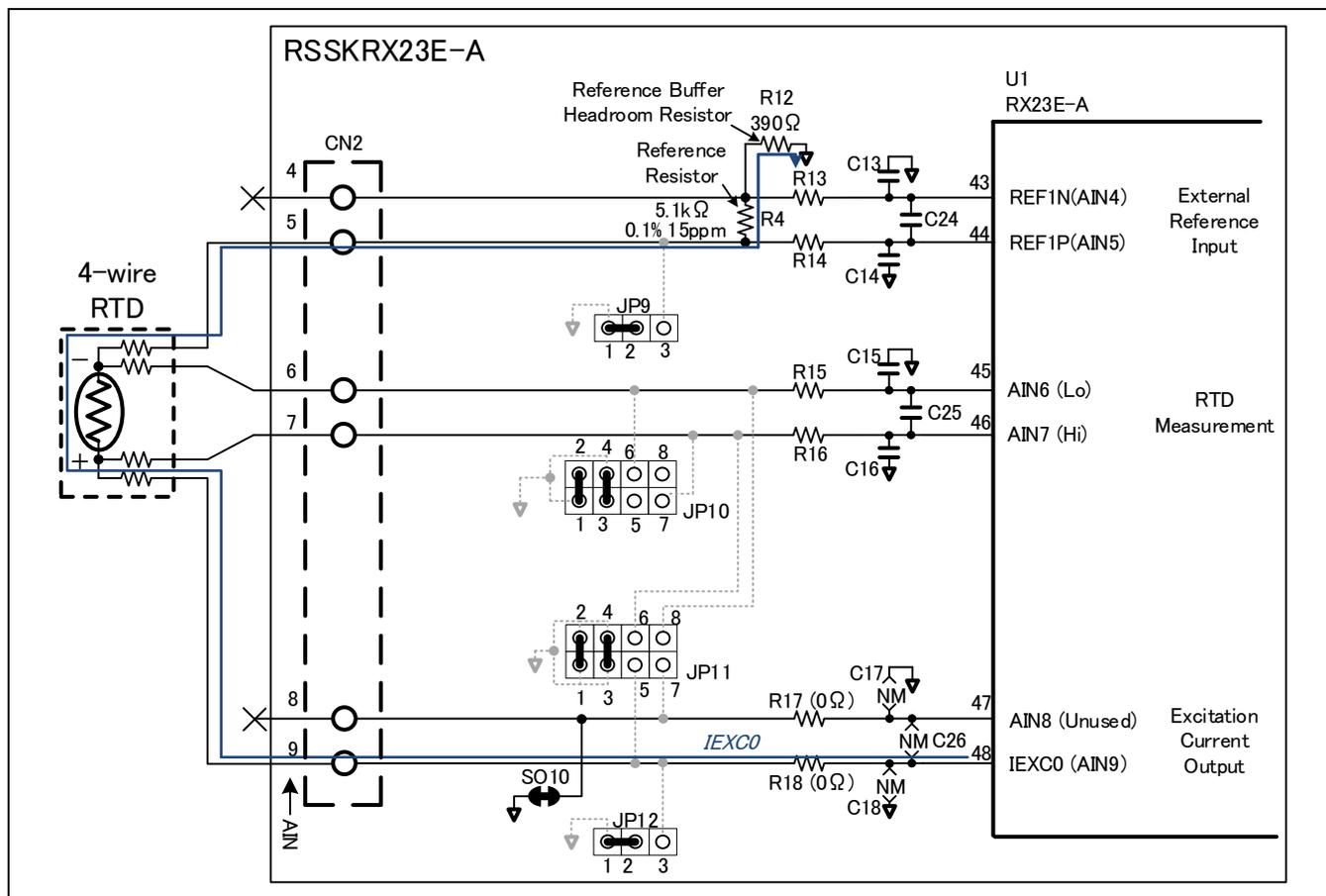
図 2.6 4 線式 RTD 計測回路
