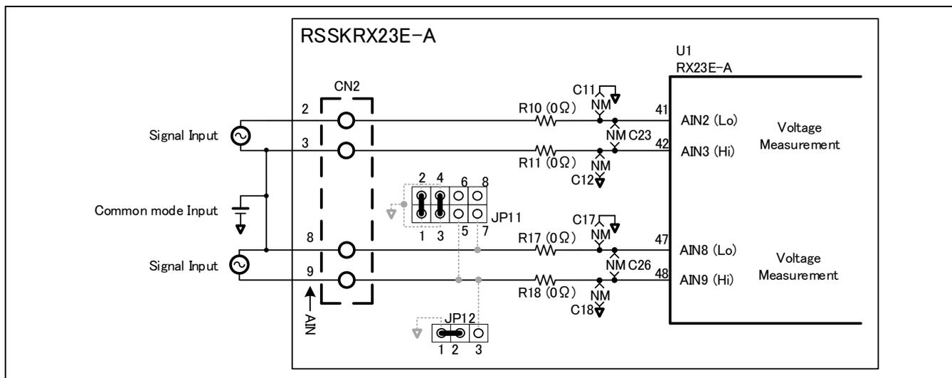
図 2.3 DSAD 計測回路使用例
