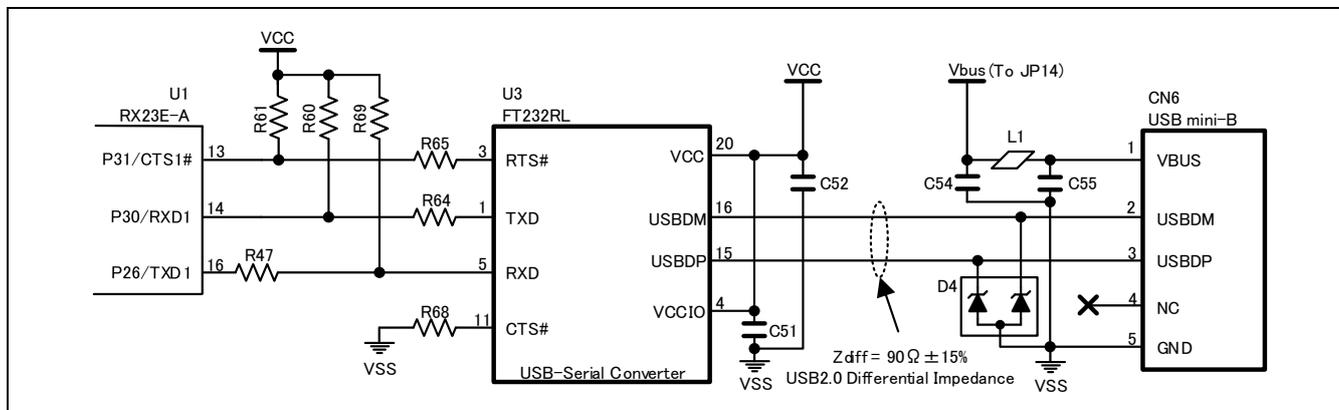
図 3.1 USB シリアル通信回路
