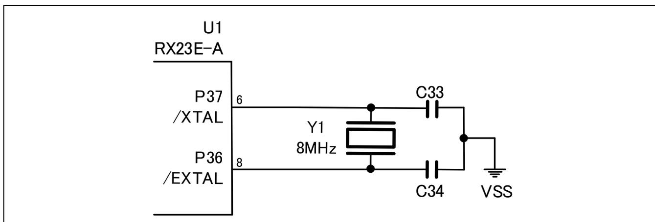
図 3.7 外部クロック入力回路
