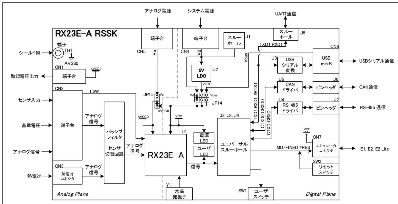
図 1.1 RSSKRX23E-A ボード システムブロック図
