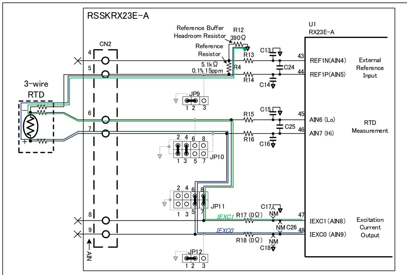
図 2.7 3 線式 RTD 計測回路
