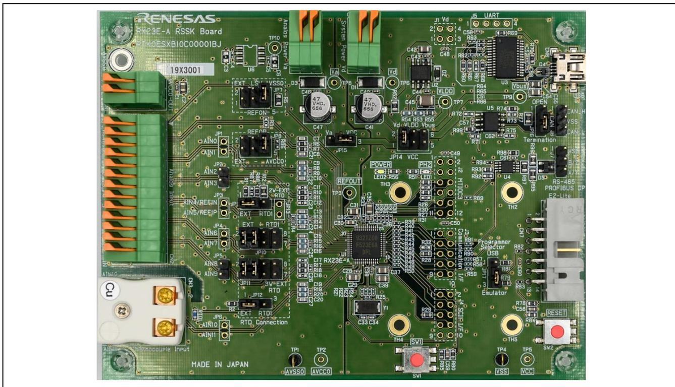
図 1.2 RSSKRX23E-A ボード 概観 (表面)
