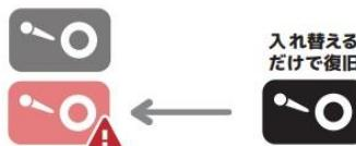
※1 ホットスワップには対応していません。HDDを交換する場合は、パソコンから本製品を取り外し、本体の電源をオフにした状態で交換してください。
