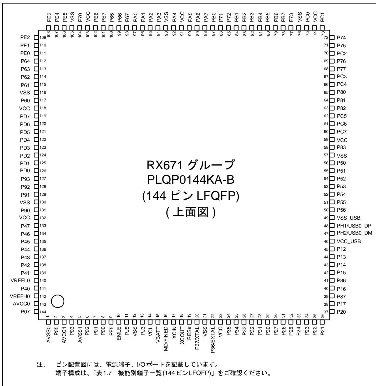
図 1.5 ピン配置図(144ピン LQFP)
