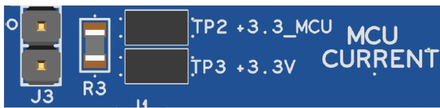
図 23 RA MCU 電流測定
