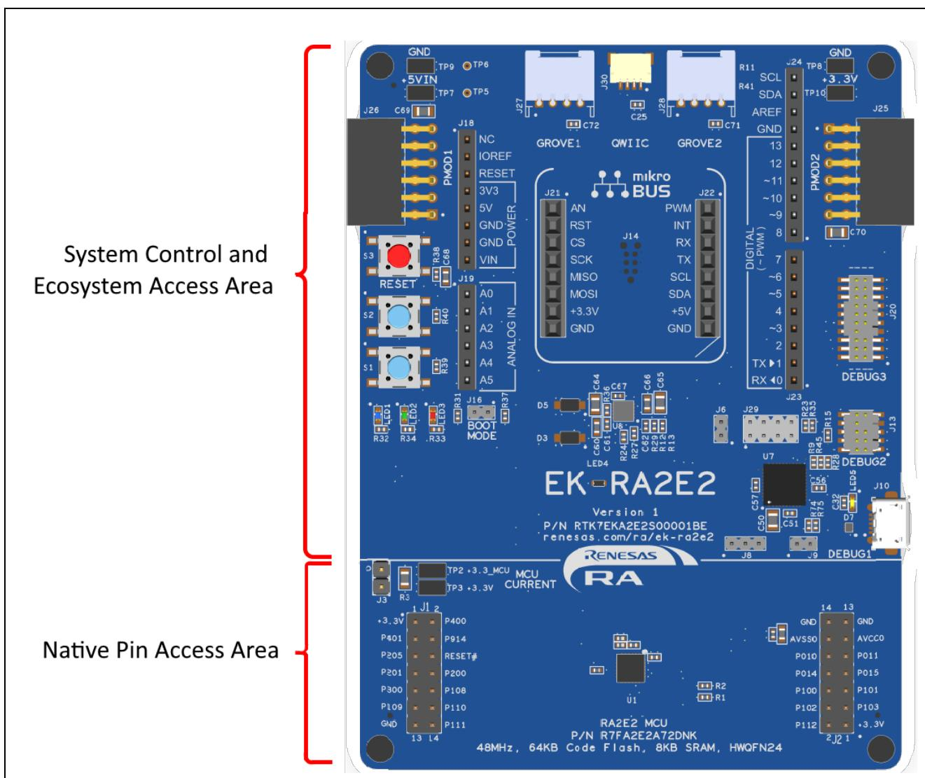
図 4 EK-RA2E2 ボードの機能エリアの定義
