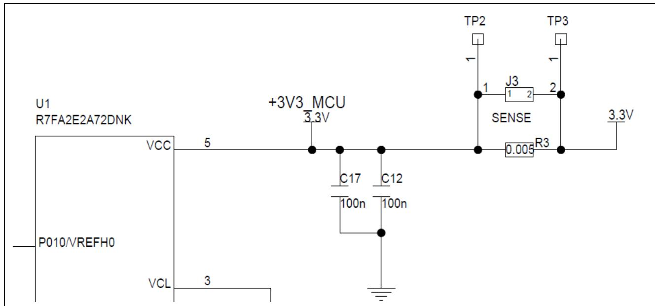
図 22 RA +3.3 V 電流測定回路
