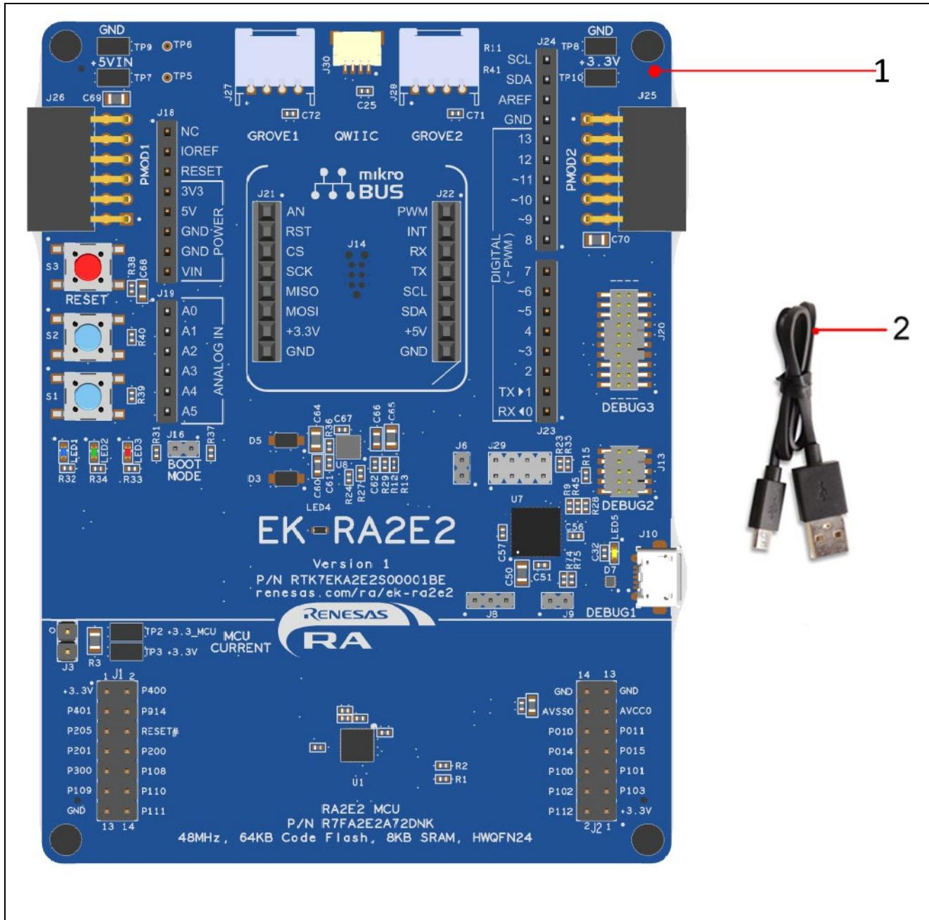
図 3 EK-RA2E2 v1 評価キット構成
