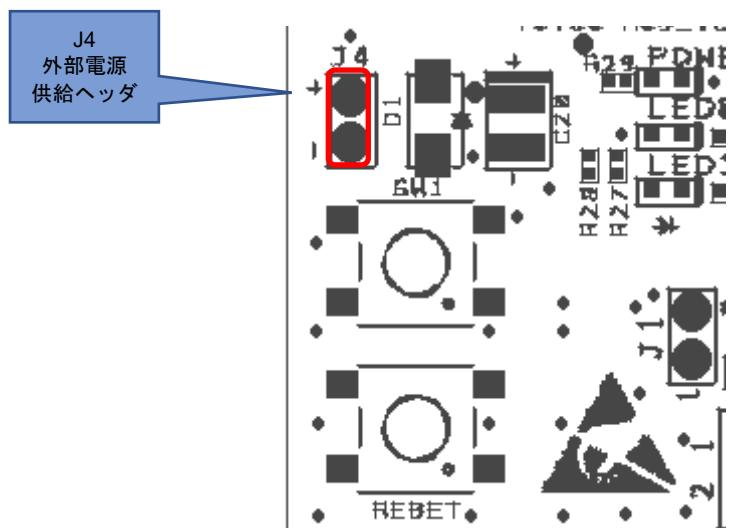
図 5-2 : J4 外部電源供給ヘッダ位置(部品面)
