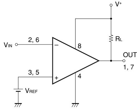
$V_{REF}$ :  $V^-$  to  $V^+ - 1.5$  (V)
