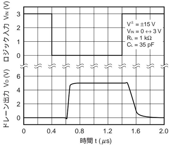
スイッチング特性 ( $V_{ANALOG} = 0\text{ V}$ )
