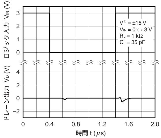
スイッチング特性 ( $V_{ANALOG} = -5\text{ V}$ )
