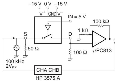
図3 チャネル間クロストーク測定回路
