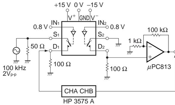
図4 スイッチング・トランジェント測定回路
