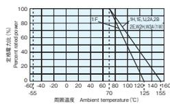
周囲温度70℃以上で使用される場合は、上図に示す負荷軽減曲線に従って、定格電力を軽減してご使用ください。
