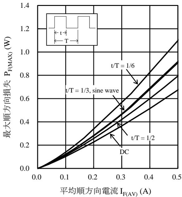
図4  $P_{F(MAX)} - I_{F(AV)}$ 特性 ( $T_J = 150^\circ\text{C}$ )
