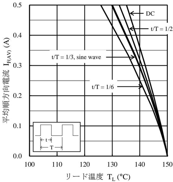
図2  $I_{F(AV)} - T_L$  特性<sup>(2)</sup> ( $T_J = 150$  °C、 $V_R = 0$  V)
