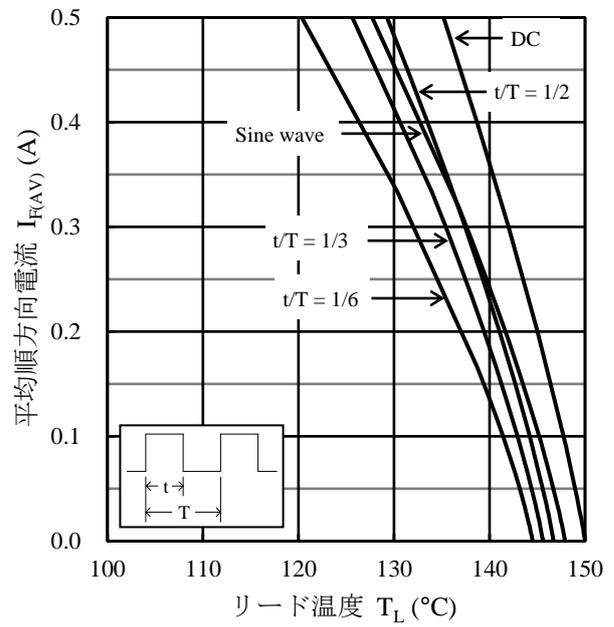
図3  $I_{F(AV)} - T_L$  特性<sup>(2)</sup> ( $T_J = 150$  °C、 $V_R = 600$  V)
