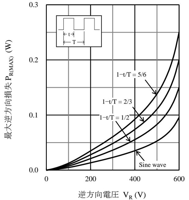
図5  $P_{R(MAX)} - V_R$ 特性 ( $T_J = 150^\circ\text{C}$ )
