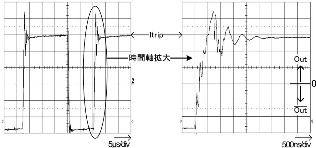
PWM がオン→オフの直後に数  $\mu\text{s}$  の期間、Sense 端子にはスパイク状のノイズ（リンギングノイズ）の発生が確認できます。このリンギングノイズは「モーターコイルの線間容量」、「モーター配線の引き回し」等により発生仕方がさまざまです。
