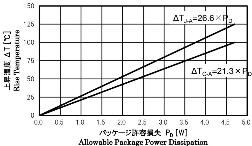
製品に放熱板を付けて使用される場合、 $\Delta T_{J-A}$  を算出するパラメータの中で製品の熱抵抗  $\theta_{J-A}$  が変化します。この値は放熱板の熱抵抗を  $\theta_{FIN}$  とすると
