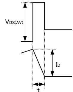
図 12-3 ブレイクダウン時波形図
