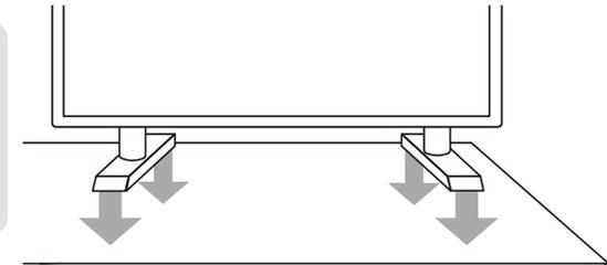
※モニター以外の固定に関しても対象物の底面に4点もしくは6点貼り付け固定してください。
