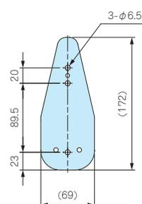
耐荷重：6.5kg (調整ボルト締付時、製品自重含み)
