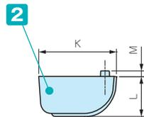
■ EX□シリーズの下カバーの幅が185mm以上にあります。ナットスライド用溝を利用して取り付けすることができます。(TLW-70E□のみ)
