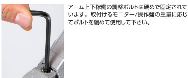
アーム上下稼働の調整ボルトは硬めで固定されています。取付けるモニター/操作盤の重量に応じてボルトを緩めて使用して下さい。
