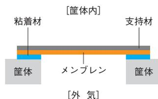
粘着材タイプは、平面さえあれば場所を選ばず使用可能です。携帯機器の防水としても広く使用されています。
