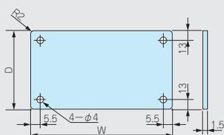
小型から中型のケースに適しています。比較的、軽量の物をシャーシ上に載せる場合に選定して下さい。
