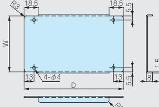
中型から大型のケースに適しています。D方向（奥行き）が広いタイプで重量のある物を載せる場合などシャーシのたわみを防ぎたい場合に選定して下さい。
