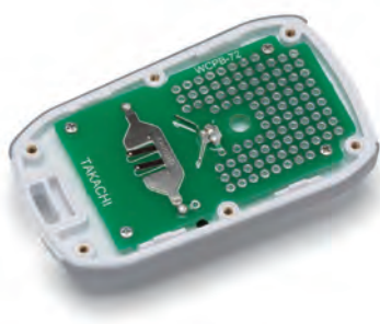
ケース上カバーもしくは下カバーに基板を取付け
