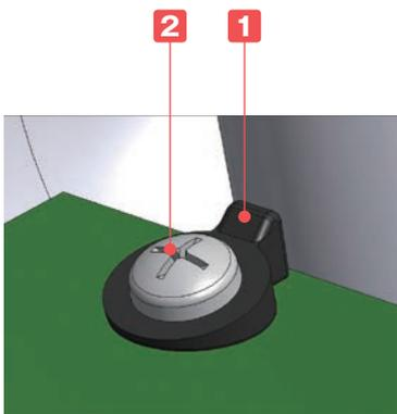
■ WSCシリーズはベース側の基板取付ボスが金型構造上斜めとなる為、取付ビスも斜めとなり、ビスと基板の間に隙間が発生します。隙間を気にされる場合は、傾斜スペーサーをご使用ください。ベース側用にEM-2.3-8タッピングビス、カバー側用にEM-2.3タッピングビス(P1-124)をご用意しています。
