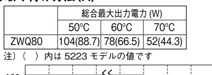
注) 強制空冷の仕様でご使用になる場合は、電源部品面に風量0.85m<sup>3</sup>/min (30CFM) の風をあてて下さい。
