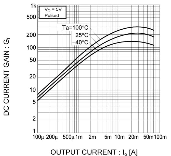
●電気的特性曲線 ( $T_a=25^\circ\text{C}$ )
