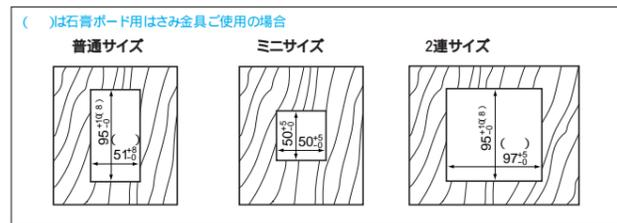
器具取付けの穴あけ寸法(ボックス工事の場合)
