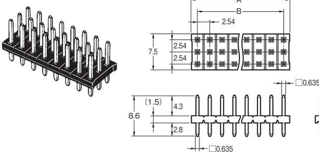
プリント基板加工寸法 (BOTTOM VIEW)
