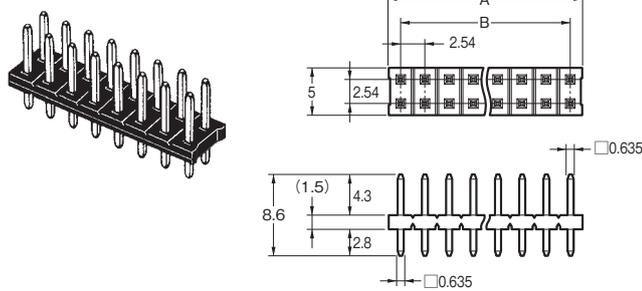
プリント基板加工寸法 (BOTTOM VIEW)
