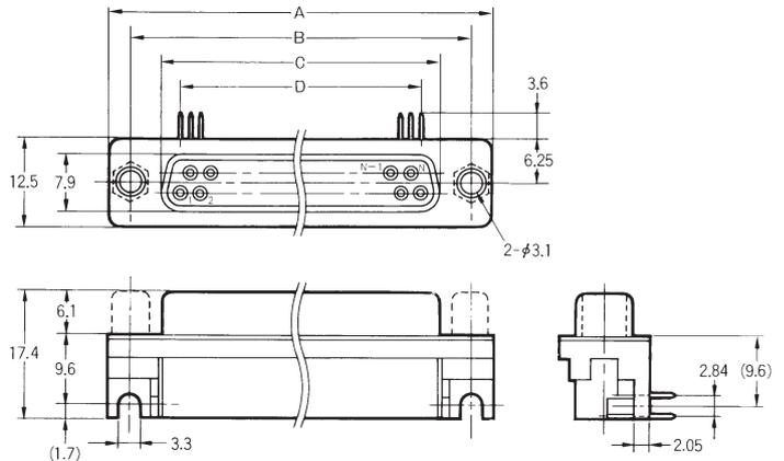
プリント基板加工寸法 (t=1.6mm、BOTTOM VIEW)
