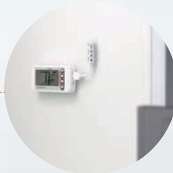
クリーンルーム内の 温湿度常時計測 温湿度ステーション
