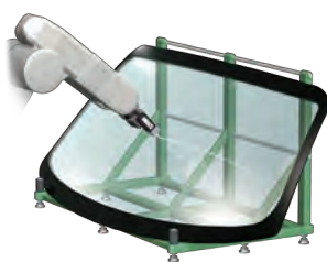
ガラス面の曲率測定
