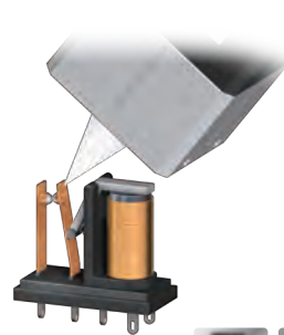
リレー接点部の動作確認
