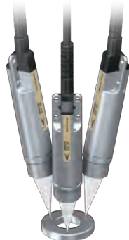
モジュール部品組立前の部品平行度測定
