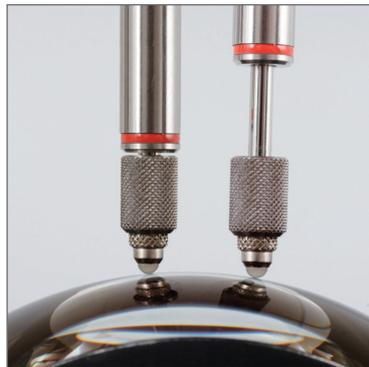
測定子部の自重によって微圧加重でコンタクトするため、非接触センサでは安定検出ができなかった透明体や光沢のあるワーク、また変形しやすく、傷つきやすいワークの測定に最適です。
