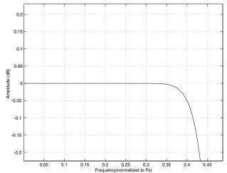
Figure 24. Quad-Speed Transition Band
