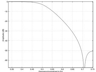
Figure 22. Quad-Speed Stopband Rejection
