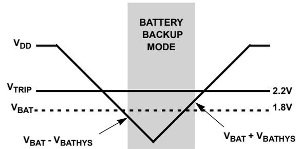
FIGURE 13. BATTERY SWITCHOVER WHEN  $V_{BAT} < V_{TRIP}$
