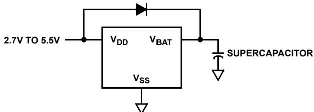
FIGURE 28. SUPERCAPACITOR CHARGING CIRCUIT
