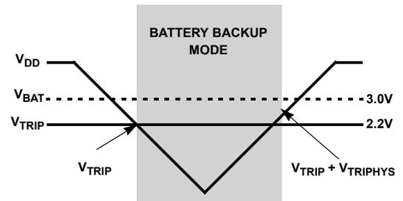
FIGURE 14. BATTERY SWITCHOVER WHEN  $V_{BAT} > V_{TRIP}$
