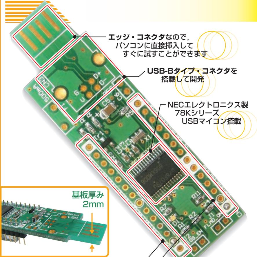
入出力端子の形状は、DIPタイプの28ピンICと同じです
