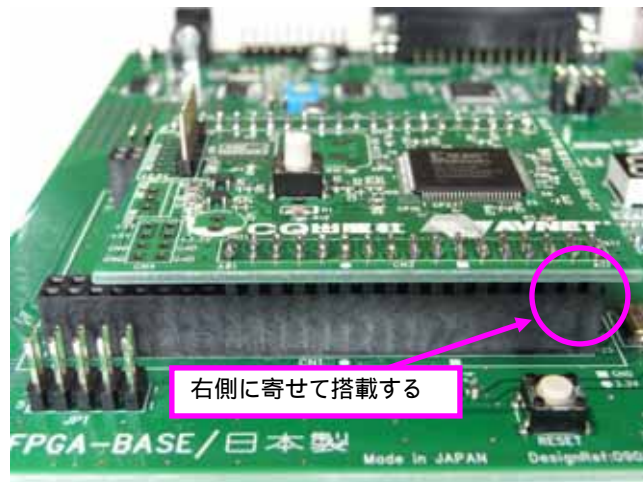
写真 2 Spartan3E 基板の搭載方法
