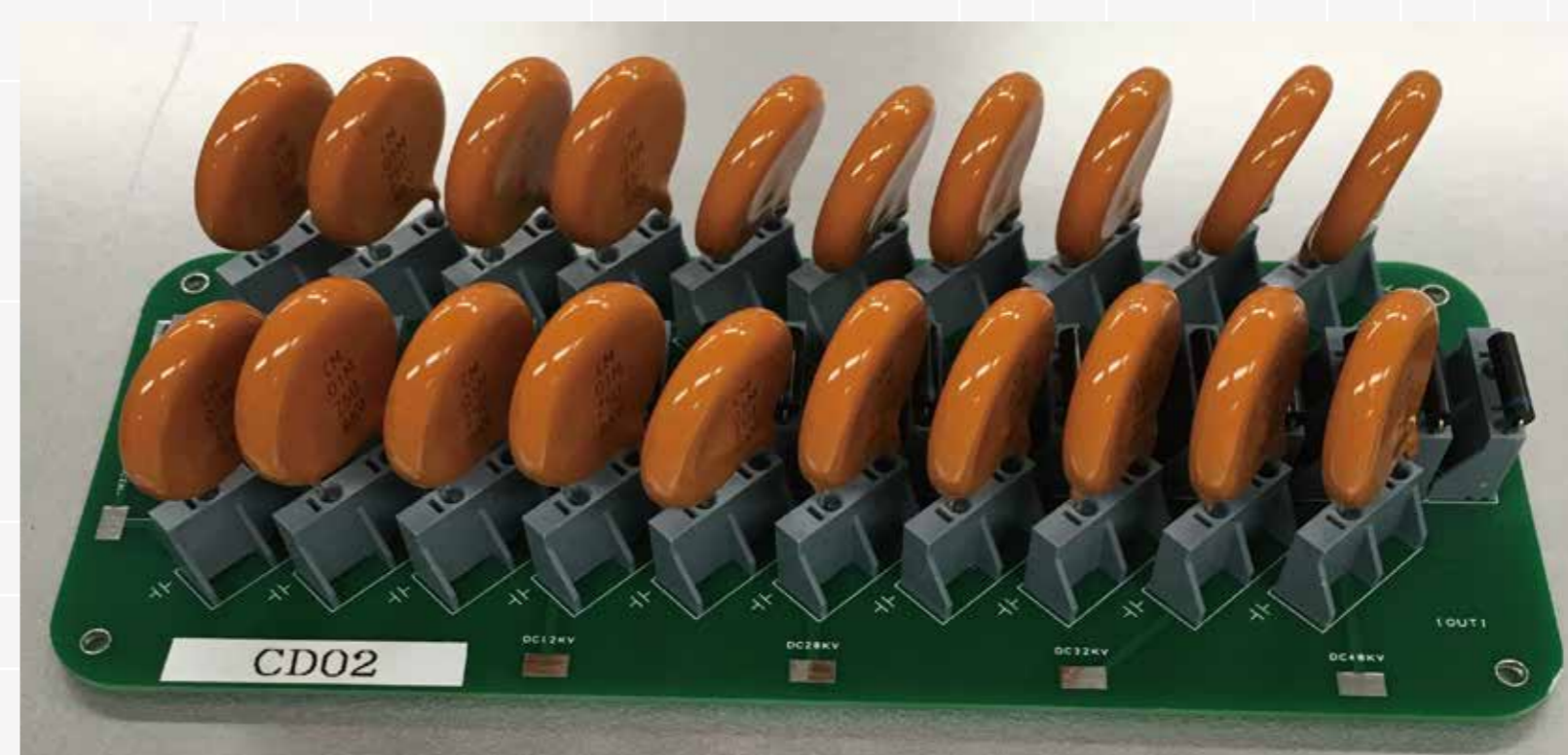
コンデンサとダイオードを挿入
