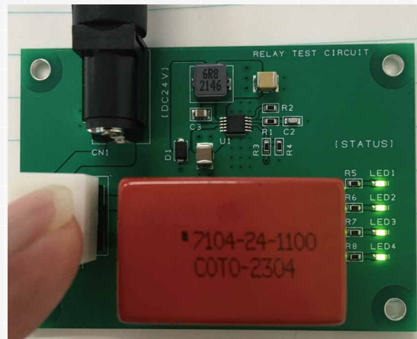
プッシュボタンを押して、4ch の信号を LED で確認
